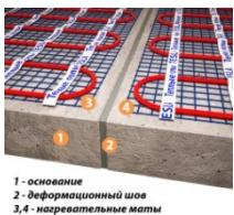
**3. Подготовьте основание пола**, инструменты и материалы, необходимые для монтажа системы. Поверхность пола, на которую устанавливается «теплый пол» должна быть чистой, ровной и грунтованной. В случае, если здание имеет деформационные швы, нагревательные маты должны быть расположены так, чтобы исключалась всякая возможность прохождения кабеля через шов.
