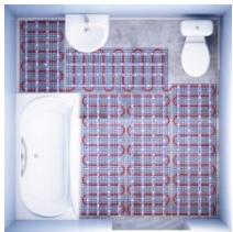
**1. Определите обогреваемую площадь** и составьте чертеж, исходя из площади и индивидуальных особенностей помещения, с указанием расположения секций тёплого пола. Укажите места соединений полос теплого пола между собой (соединение токоведущего провода и питающего провода) и места изоляции токоведущих проводов. Расстояние между полосами примерно 5 см.
